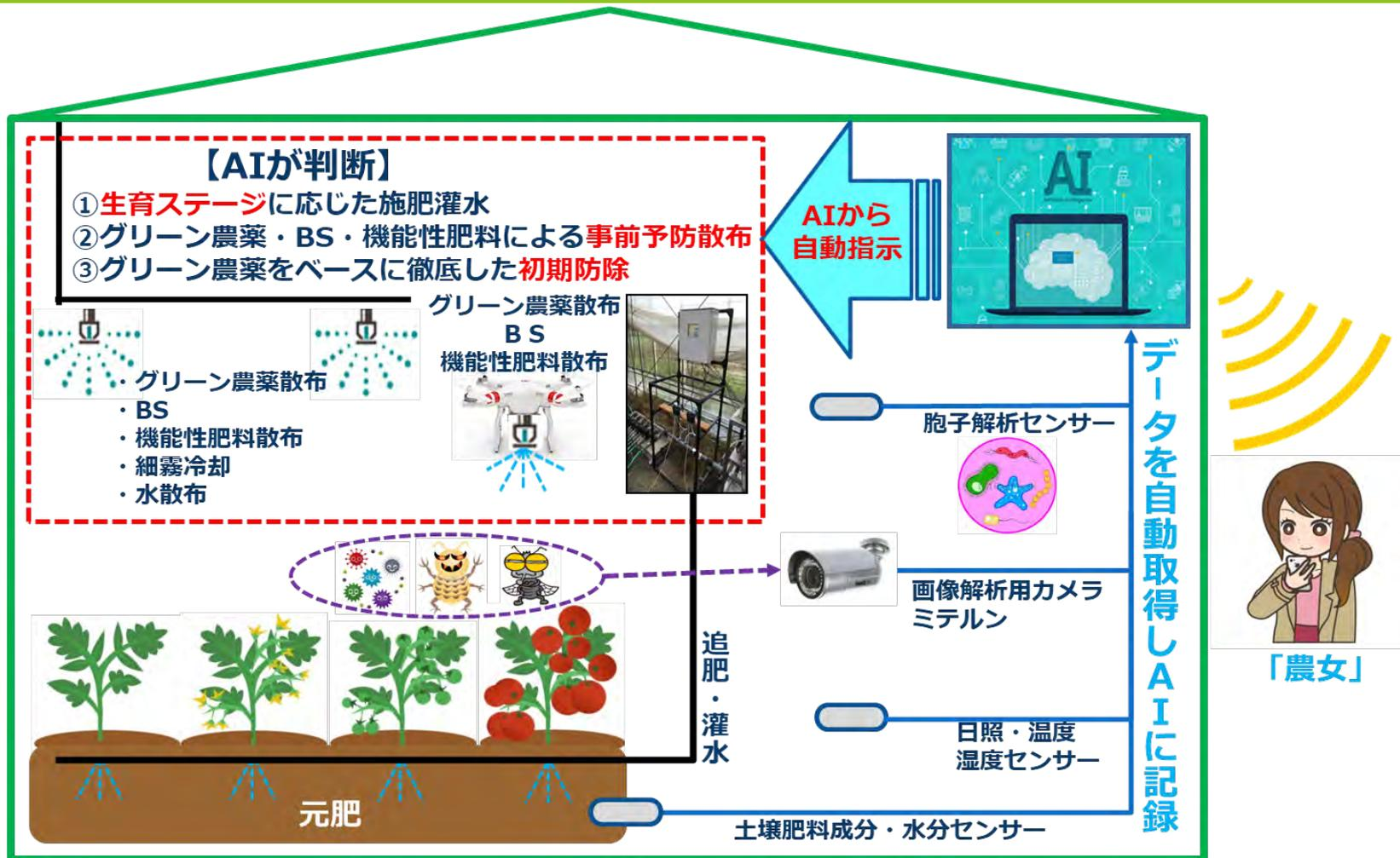
各種センサー/カメラ・AIによる自動診断により、生育ステージに応じた栽培を可能にすることを目指します。
